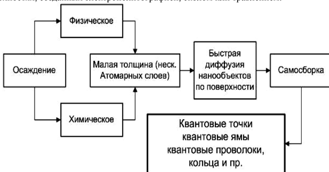
Рис. 1.1.9. Схема создания квантовых наноструктур
